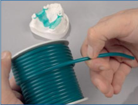
Pour la coulée, des canaux de coulée d'un diamètre de 3,5–4 mm vont être utilisés.
