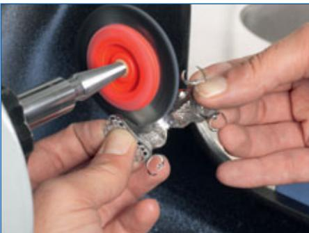
Sur le tour à polir, la coulée de modèle va être polie à grand brillant, à l'aide d'une brosse spéciale pour coulée de modèle et de la pâte à polir *Saphir*.
