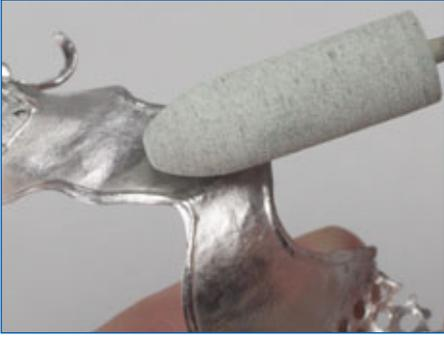
Sans pression exagérée, la surface est prépolie facilement à l'aide de *Polisoft*, le polissoir en caoutchouc.
