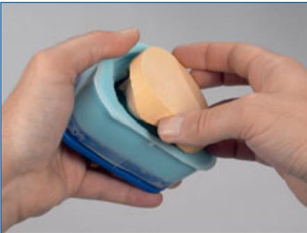
Après son enlèvement le modèle en plâtre va être ôté avec précaution de la forme de reproduction.
