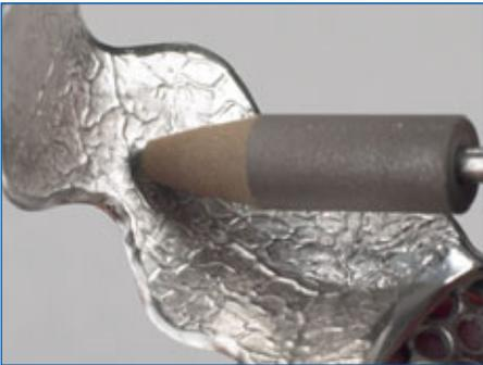
La surface veinée va, avec une faible pression, être également prépolie à l'aide du cône de polissage en caoutchouc. Là il faut faire attention à ce que la structure veinée reste intacte.
