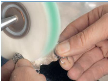
Pour le polissage grand brillant un disque de polissage plissé en coton et une pâte de polissage verte sont utilisés.
