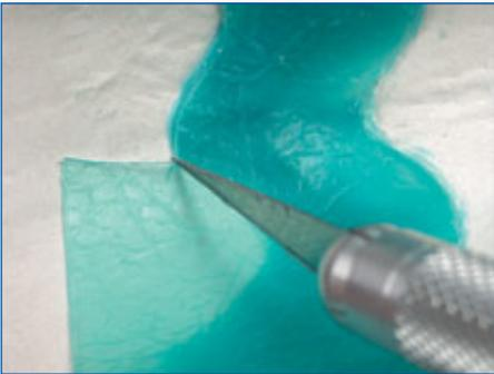
La plaque de cire granitée va être coupée en suivant exactement le contour du bord. La transparence de la cire de coulée facilite la coupe correcte.
