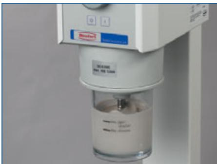
Le mélange de revêtement pour coulée va être mélangé sans bulles, selon les indications du fabricant, dans un appareil de malaxage sous vide.
