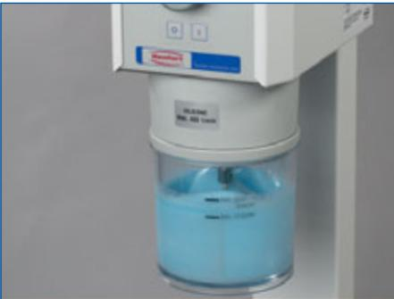
Le silicone de doublage va être malaxé sans bulles dans l'appareil de malaxage sous vide.
