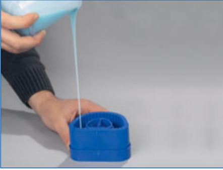
Le silicone de duplication va être rempli lentement dans la cuvette pour le duplicata, et ce à partir d'une hauteur de 30 cm.
