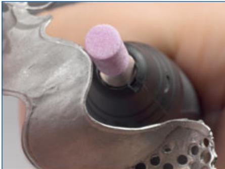
Les bords de fermeture du joncteur transversal vont être élaborés avec un gros abrasif pour obtenir un tracé harmonieux.
