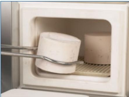
Maintenant le moufle avec l'ouverture de l'entonnoir de coulée placée vers le bas peut être posé dans le four de chauffe.
