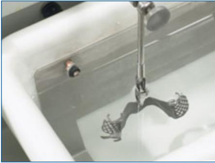
Pour éviter un dégât possible sur la coulée de modèle les données du fabricant sont à respecter pour le processus de brillance, évent. placer sur les parties fragiles ( pointes des crochets) une laque de protection.
