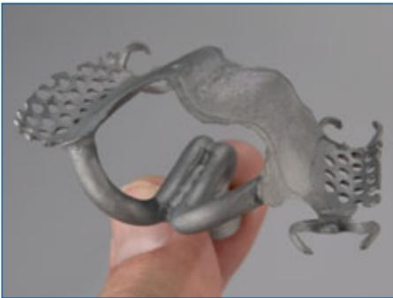
Après le sablage la coulée de modèle doit être exempte de revêtement et d'oxyde.
