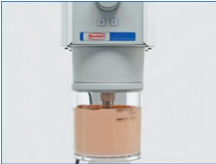
Pour confectionner le modèle de travail utiliser un plâtre de la classe IV et malaxer sans bulles dans un appareil de malaxage sous vide.
