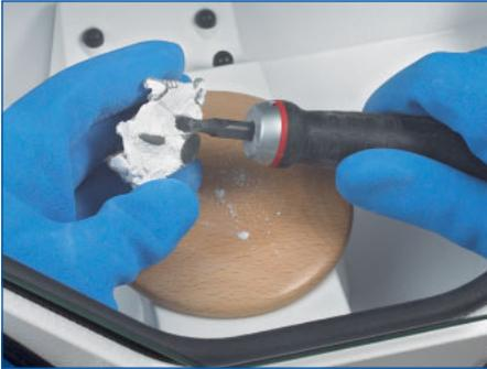
Pour éviter des rétractions dans la coulée de modèle un burin pneumatique devrait être utilisé pour effectuer le gros démoulage.
