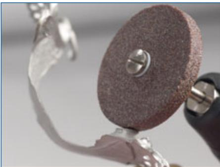
Les reste des canaux de coulée peuvent être enlevés et lissés rapidement et effectivement à l'aide d'un disque abrasif.
