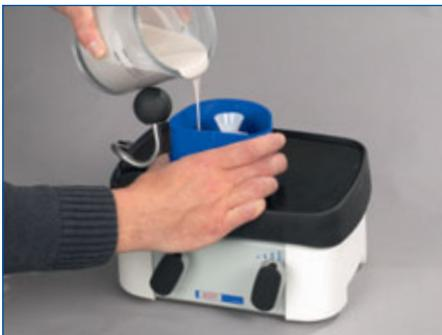
Le remplissage de la pâte de revêtement doit se faire lentement et à l'aide d'un niveau de vibration correspondant au matériau.
