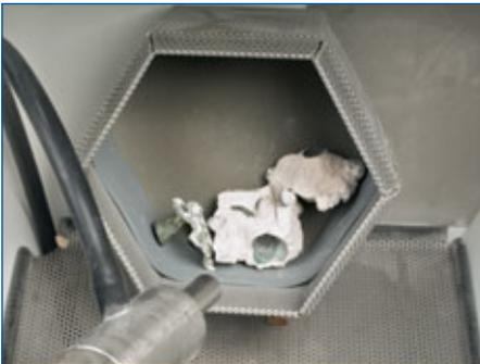
Après le démoulage grossier, pour gagner du temps la coulée de modèle devrait être sablée dans un appareil de sablage rotatif automatique ...
