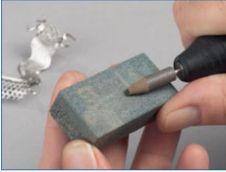
Avec une pierre à dégauchir les pointes de polissage peuvent être mises rapidement dans la forme désirée.
