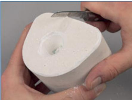
Sur l'entonnoir de coulée et sur la surface externe des moufles les bords acérés doivent être ôtés.
