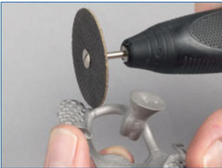
A l'aide d'un disque à tronçonner renforcé de fibres de verre séparer, à env. 1 mm de l'armature, les canaux de coulée.
