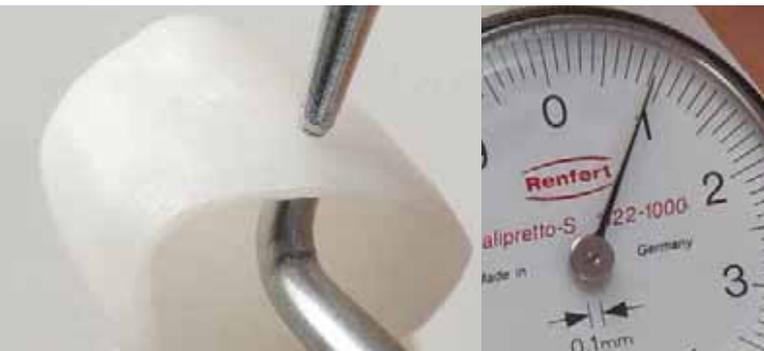
Système de mesure précis permettant de déterminer l'épaisseur des parois des éléments de la prothèse dentaire.
