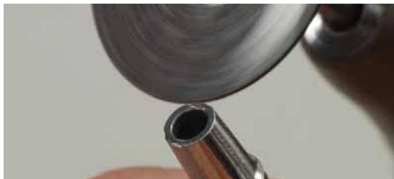
Disque de meulage flexible, stable, renforcé de fibres de verre, conçu spécialement pour la coupe et le meulage de suprastructures d'implants comme les piliers, les barres et les châssis de titane ou d'alliages de titane.
