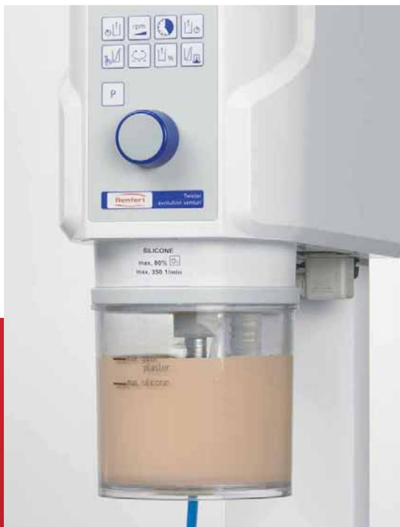
« Un avantage essentiel pour vous est que vous obtenez des résultats de mélange toujours homogènes : avec leur régime de 100–450 tr/min, les moteurs puissants des appareils Twister maintiennent aisément les vitesses de malaxage réglées, quelle que soit la situation. »
