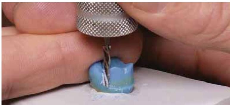
Cire de fraisage dure et opaque conçue pour une utilisation à la machine dans le cadre du modelage à la fraise. Grâce à son point de fusion bas et son petit intervalle de fusion, la cire de fraisage permet un modelage rapide et économique et le fraisage de restaurations télescopiques, coniques et des attachements en cire.
