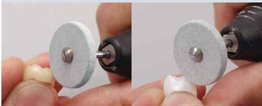
« Pour le prépolissage des matériaux comme le disilicate de lithium, l'oxyde de zirconium, les céramiques hybrides et de revêtement esthétique ainsi que les polymères haute performance et les résines composites de revêtement, j'utilise le polissoir en silicone (No. 86 0000). Je trouve qu'il est indispensable pour obtenir rapidement et efficacement un polissage grand brillant réussi. »
