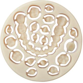
Polymère acrylique à base de polyméthacrylate de méthyl à masse moléculaire élevée, fortement réticulé et renforcé, très similaire à celle utilisée dans la fabrication des dents artificielles. Ses pigments minéraux garantissent sa stabilité chromatique, permettant de créer des prothèses provisoires d'une très grande qualité et longue durée.
