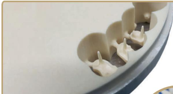
Indication : Préparation d'inlay-cores anatomiques en composite fibré via les systèmes de CFAO dentaires.
